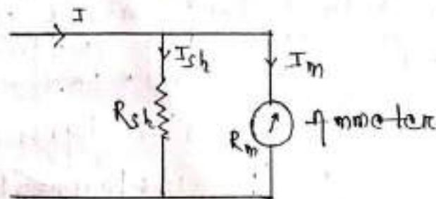
Fig: Basic ammeter
